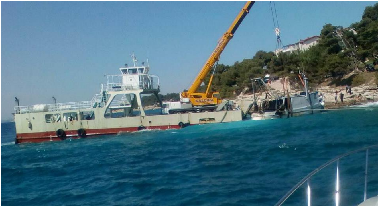
Slika 3. Podizanje ribarskog broda "Rom" prije odsukavanja i tegljenja u brodogradilište (izvor: Lučka kapetanija Šibenik)
