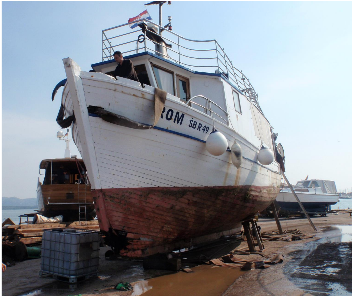
Slika 4. Ribarski brod "Rom" na suhom u Marini Vinici - oštećenje broda gledano sa pramca lijevo (izvor: Lučka kapetanija Šibenik)
