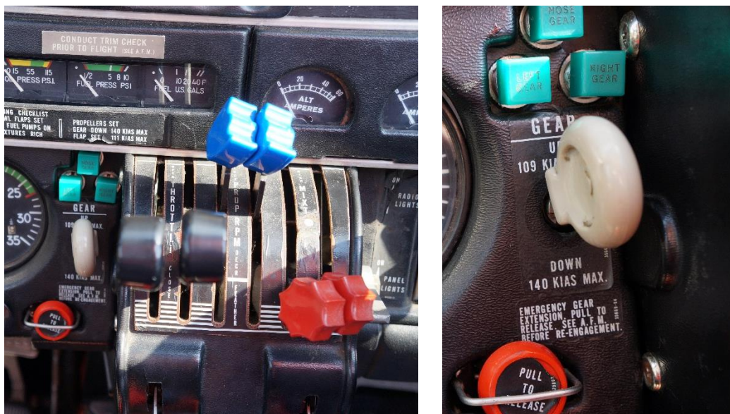
Slika 2. Položaj komandi (ručica potiska – crna, broj okretaja propelera – plava, ručica smjese – crvena i ručica položaja stajnog trapa – bijela)
